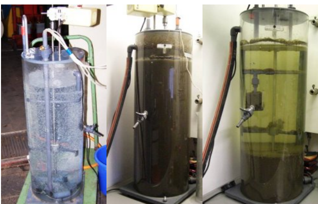
Abbildung 3: SBR-Reaktor (links: Inbetriebnahme mit Reinwasser; Mitte: Betriebsphase; rechts: Absetzphase)
